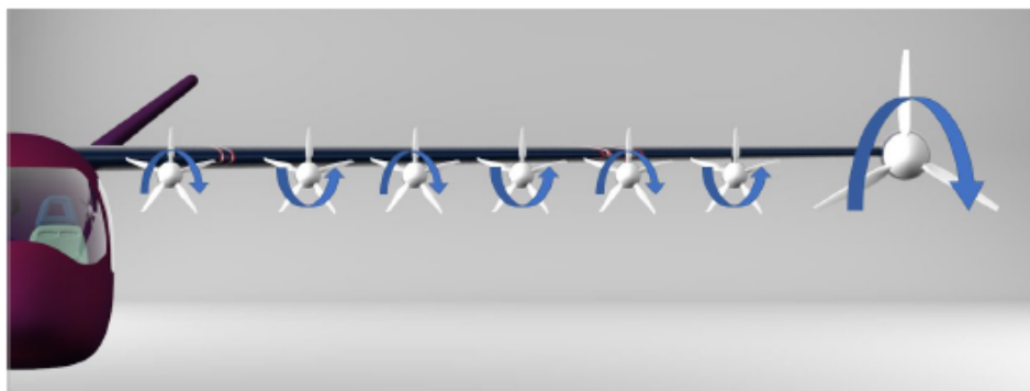
Obrázek 1.3: Znázornění nejlepší konfigurace rotací vrtulí [7]
